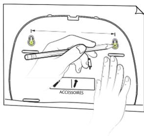
MARQUER LA POSITION AU MUR POUR PERCER LES TROUS DE MONTAGE.
