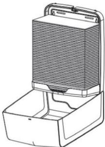
VEILLER À CE QUE LES SERVIETTES EN PAPIER SOIENT INSÉRÉES SOUS FORME DE PILE NON COMPRIMÉE DANS LE DISTRIBUTEUR.
