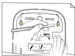
MARQUER LA POSITION AU MUR POUR PERCER LES TROUS DE MONTAGE.
