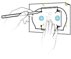
MARQUER LA POSITION AU MUR POUR PERCER LES TROUS DE MONTAGE.
