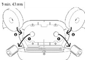
EN FONCTION DU DIAMÈTRE DU NOYAU, RETIRER (Ø MIN. 43 MM) OU INSÉRER (Ø 54-70 MM) L'ADAPTATEUR.
