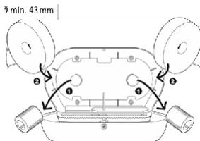
A SECONDA DEL DIAMETRO DELL'ANIMA DEL ROTOLO, RIMUOVERE (Ø MIN. 43 MM) OPPURE INSERIRE (Ø 54-70 MM) L'ADATTATORE.
