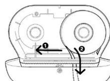
QUANDO IL PRIMO ROTOLO È FINITO, SPOSTARE LA FINESTRA PER METTERE A DISPOSIZIONE IL SECONDO ROTOLO.
