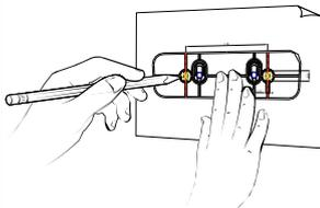
HAUTEUR DE MONTAGE RECOMMANDÉE: 450 À 550 MM
