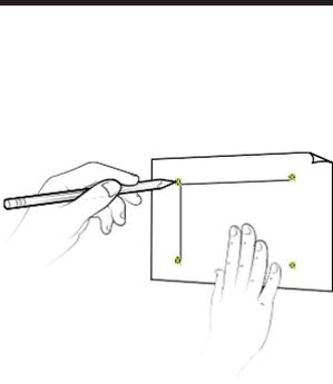
MARQUER LA POSITION AU MUR POUR PERCER LES TROUS DE MONTAGE.
